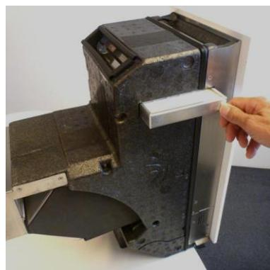
4. Reinigen Sie den Mauerkasten mit Seifenlauge. Achten Sie bitte auch auf evtl. Klebstoff-, Putz- und Farbreste, damit die Dichtungen des freeAir100 leicht in den Mauerkasten gleiten können. Danach den vorderen Rand des Mauerkastens und die Gerätedichtung umlaufend mit dem, den Filtern beigelegten Silikonfett bestreichen.
